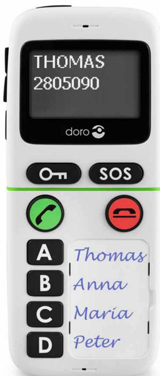
**Ce téléphone portable extrêmement facile à utiliser dispose des fonctions d'alarme automatique de perte de verticalité, de perte d'horizontalité et d'immobilité. Cet appareil est idéal pour la sécurité des personnes vivant ou travaillant seules et susceptibles d'avoir besoin d'aide.**
